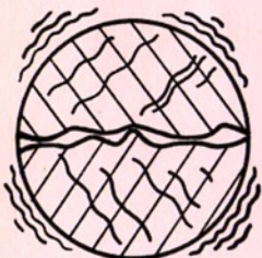
VIBRATIONS ET CORROSION USENT LES POINTS DE PORTEE
