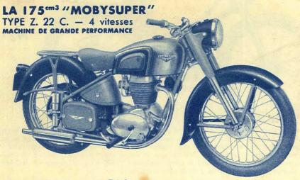
Mêmes caractéristiques que la Z 2 C mais bloc-moteur spécial à graissage sous pression par pompe - moyeux-freins monoblocs à broche de 150 AR - larges garde-boue enveloppants - pneu AR  $25\times3$ , pneu AV  $25\times3$  ligné.
