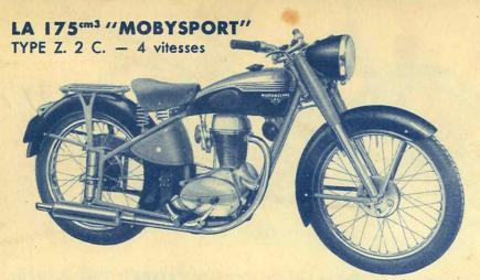
Bloc-moteur 4-temps à culbuteurs enfermés - graissage intégral par circulation intérieure automatique - commande de vitesses par sélecteur au pied - éclairage et avertisseur ali-mentés par volant magnétique, redresseur et batterie - roue arrière avec moyeu à broche jantes et réservoir chromés - compteur kilométrique - pneus 25 ×
