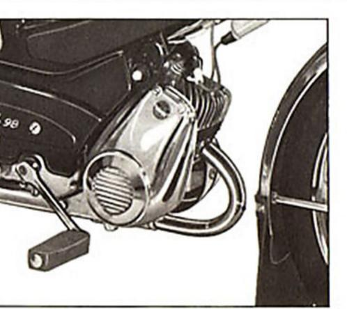
Moteur à cylindre et culasse carrés, ailetage à grande surface. Soufflante de refroidissement.
